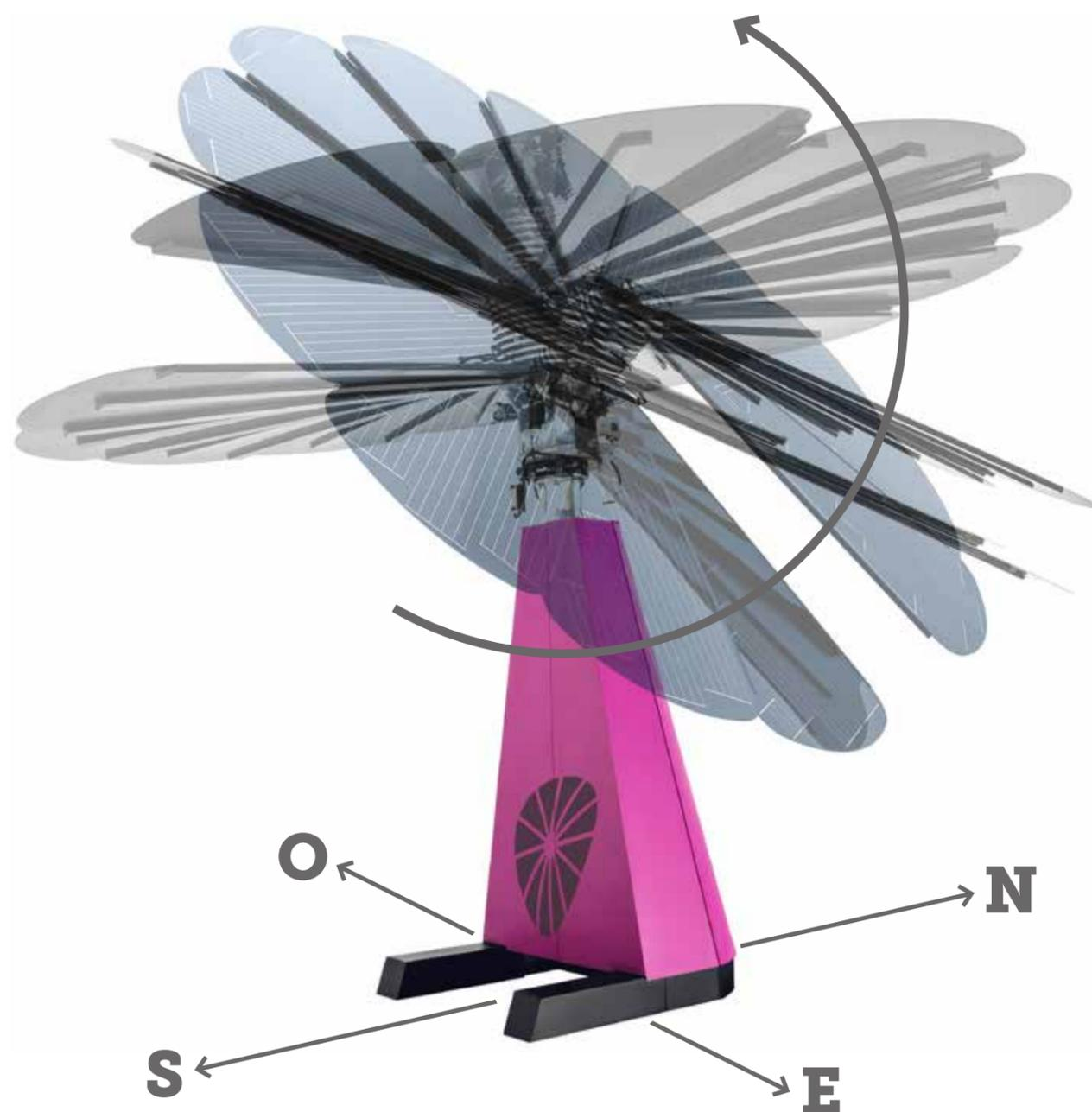
Dotati di un movimento basato su un innovativo algoritmo astronomico su due assi, i moduli fotovoltaici inseguono continuamente il sole posizionandosi sempre con un'angolazione di 90 gradi, anche quando il sole scompare dietro le nuvole. Il risultato è sorprendente: fino al 40% in più di energia prodotta rispetto a un impianto convenzionale posizionato sul tetto, che è disposto in maniera ideale rispetto al sole soltanto per poche ore l'anno.
